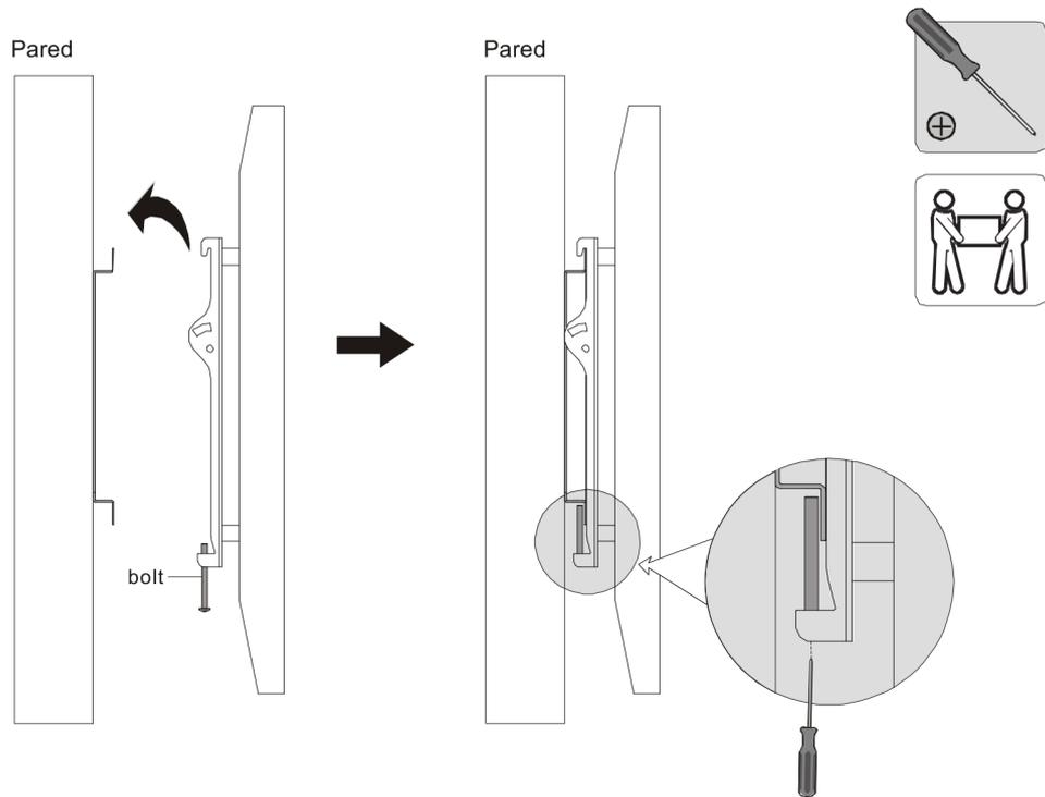
Apriete los tornillos de la parte inferior para fijar los soportes de adaptador a la placa de pared.
