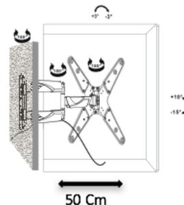
**NOTA:** Con el soporte de Brazo TSLB37, Usted puede girar su pantalla hacia los costados, ecualizar hacia arriba y hacia abajo, y permite un desplazamiento de 50 cm desde la pared hacia el frente.
